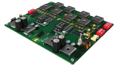
隔离: 单个演示板可以与所有三个隔离模块配合使用。
